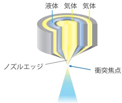
〈 高粘度材料に最適なノズル 〉
