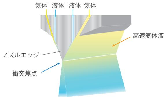
〈 10 μm 以下のミストを生成する基本ノズル 〉
